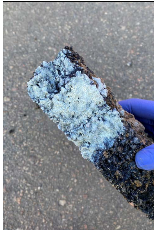
Figur 11. Asfalt från S22-4. Vit färg indikerar bitumenasfalt.
