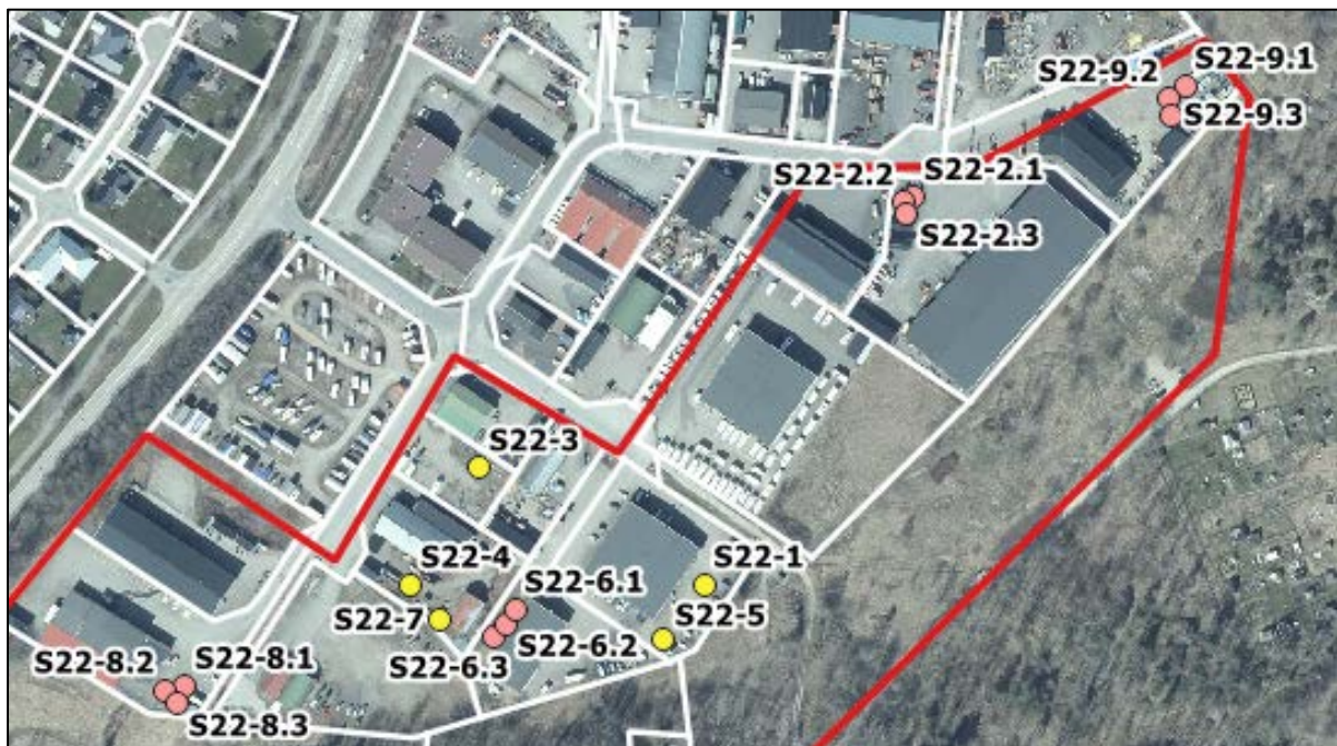
Figur 6. Lägen för provpunkter. Djupa borrningar ned till 2-3 m markerat med gult, ytliga borrningar ned till 0,5 m markerat med rosa.
