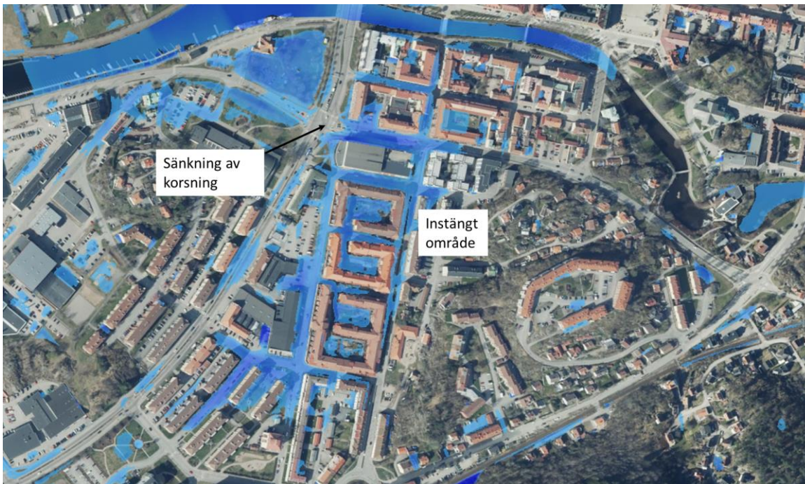
Figur 13. Sänkning av Göteborgsvägen.
