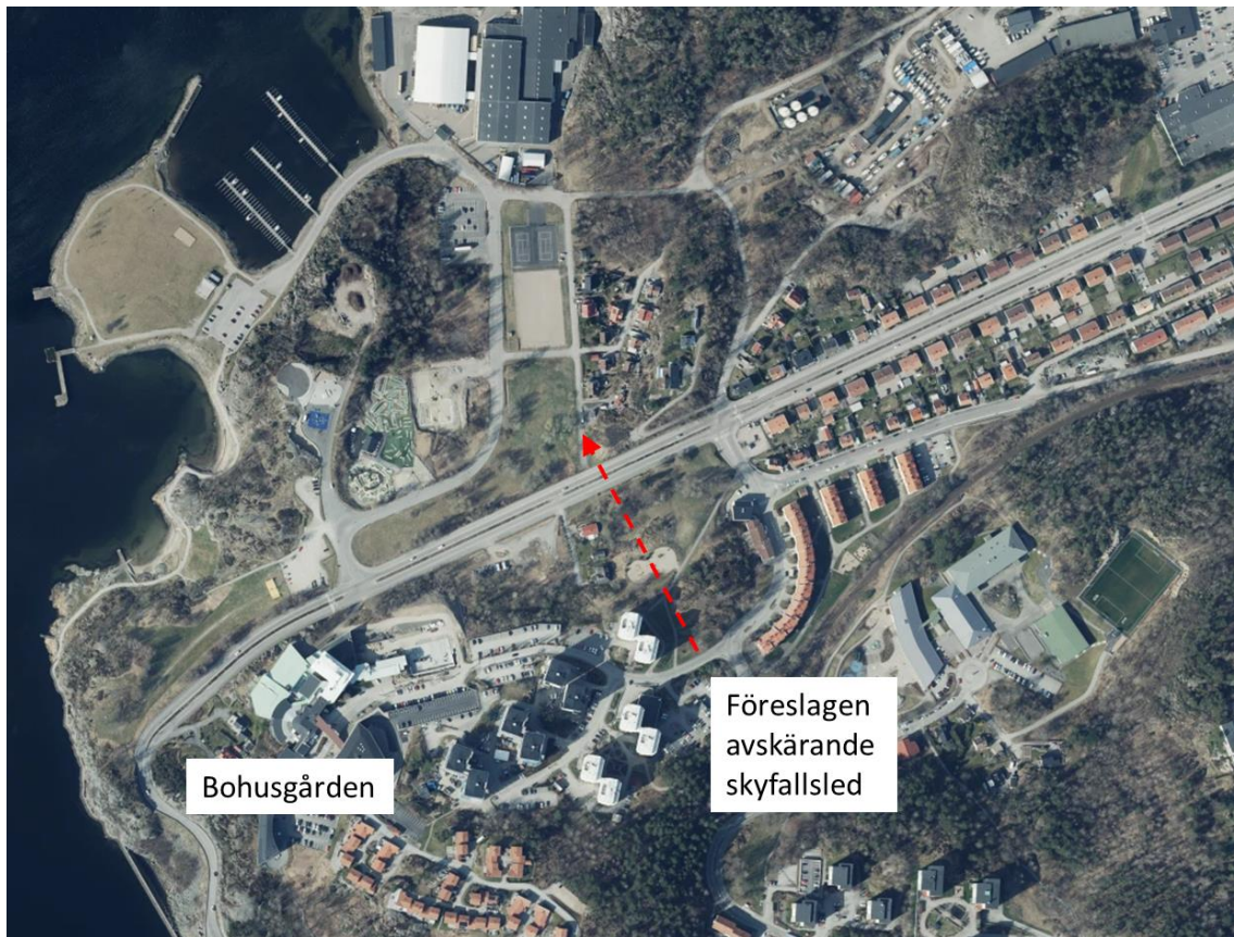
Figur 14. Omledning av skyfallsvatten från området runt Bohusgården.
