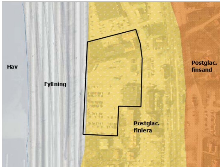
Figur 3. Geologisk karta över jordarter, aktuellt område markerat med svart linje. Jordlagren består av lera (gul färg), sand (orange färg), f.d. låglänt område som fyllts ut markerat med starta/vita streck. Källa: Sveriges geologiska undersökning (SGU).
