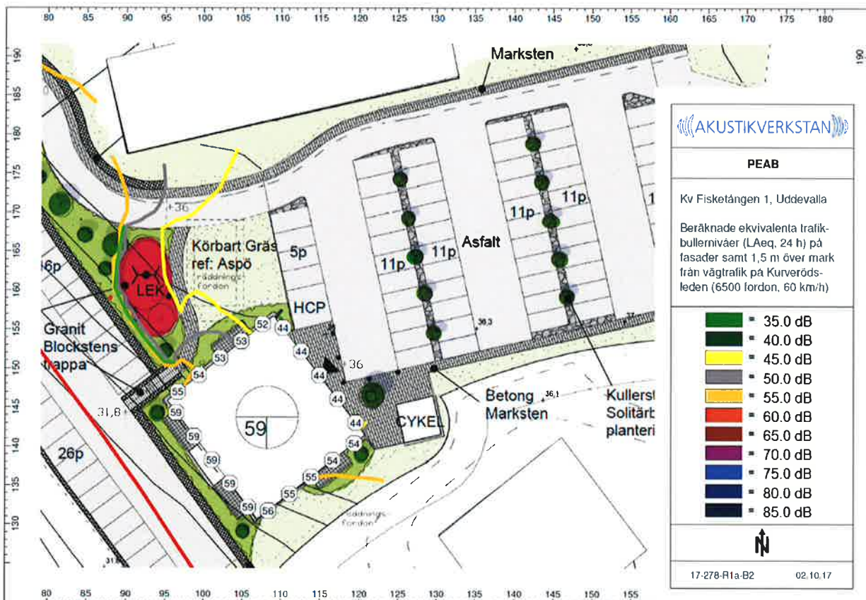
Ekvivalenta bullernivåer med 1,4 meter hög bullerskärm vid uteplatsen.
