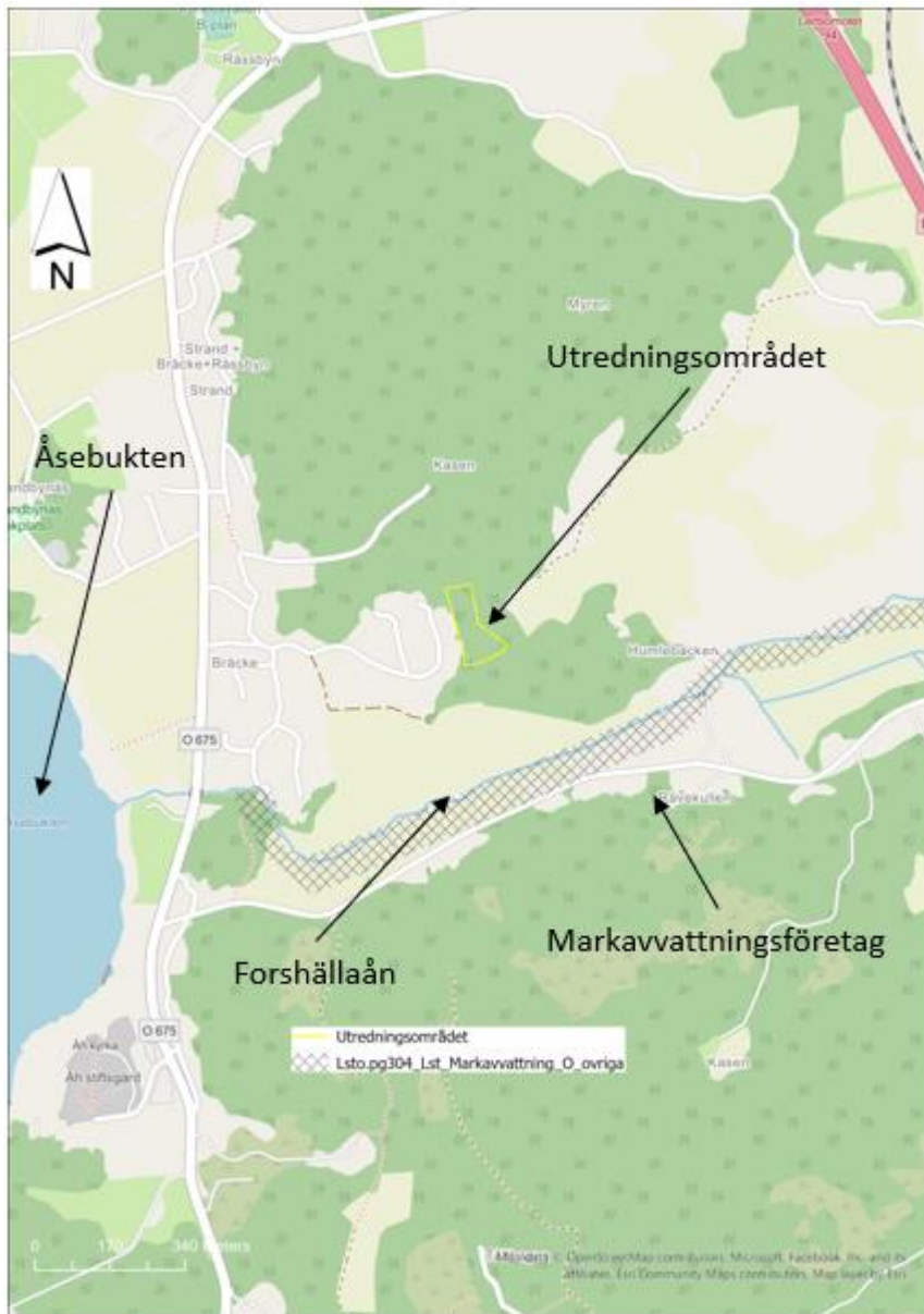
Figur 8. Markavvattningsföretaget Resteröd, Heljersöd mfl. 1894 ligger på Forshällaån, söder om utredningsområdet. Avrinning från utredningsområdet till Markavvattningsföretaget ska begränsas till 1,5 l/s,ha efter exploatering, enligt Uddevalla kommun, för att inte påverka företaget.
