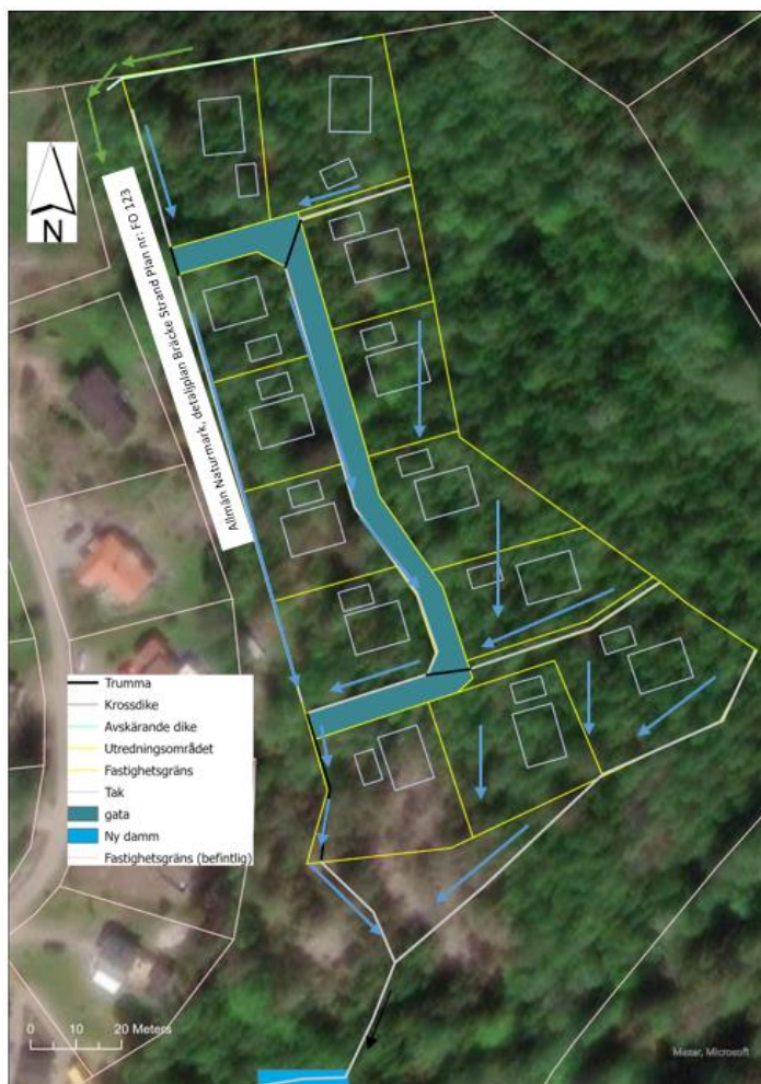
Figur 10. Förslagna dagvattenhanteringar inom utredningsområdet samt riktning på avrinningsvägar. Gröna pilar avser riktning på avrinning från uppströms utredningsområdet. Blåa pilar avser riktning på avrinning genom utredningsområdet. Anläggningarnas placering är schematisk.
