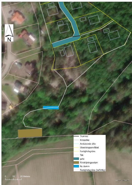
Figur 14. Dagvatten från utredningsområdet fortsätter nedströms genom ett trappat krossdike till en mindre våtdamm där vattnet renas och fördröjs. Markerade blåa ytan är en illustration av en långsmal damm där vatten kan stå året om (s.k. permanent vattenyta). Bruna ytan är en illustration av en nedstänk yta där överflödigt dagvatten kan fördröjas. Utformningen är endast ett förslag. Anläggningarnas placering är schematisk.
