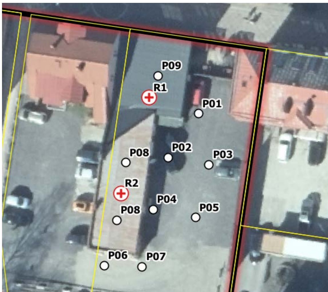
Figur 6. Rekommenderade undersökningar inom Krummeldike 17. Vita punkter markerar porgas och röda kryss inomhusluftmätning.
