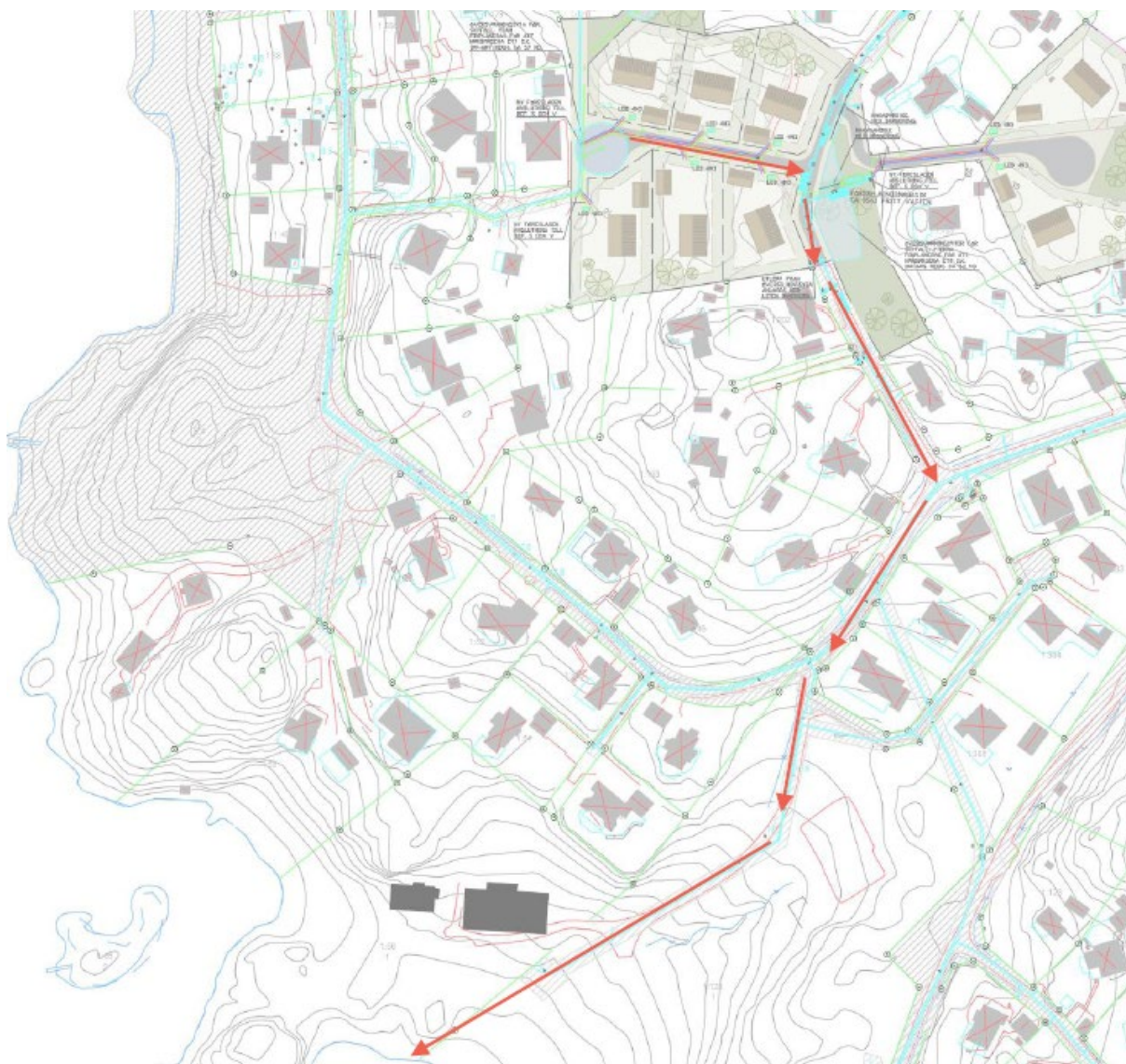
Figur 14 Föreslaget alternativ för att avleda dagvatten från planområdet. (Bild: AFRY).
