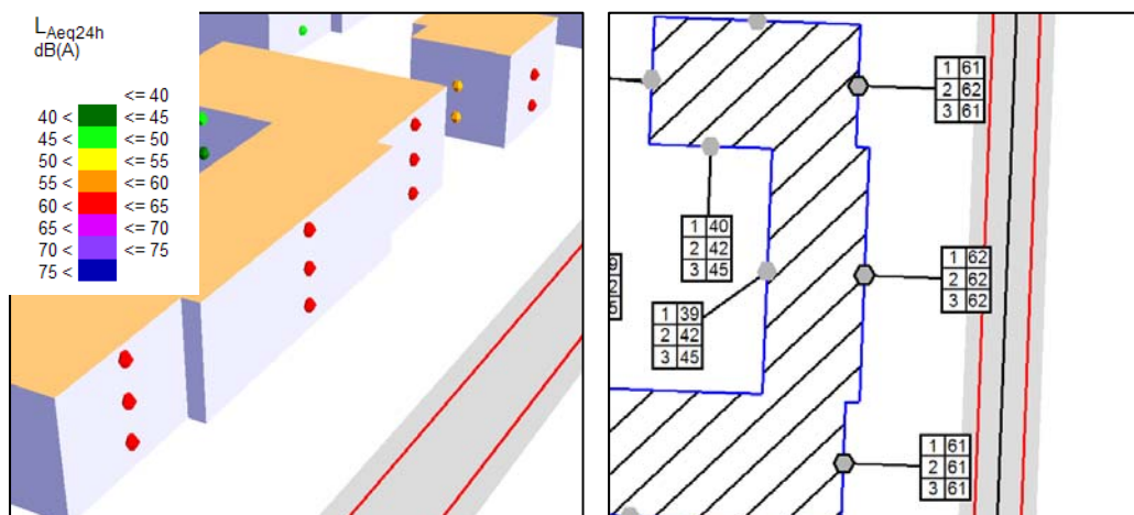
Figur 9. Exempel på sätt att redovisa fasadnivåer. Till vänster, med färgskala. Till höger, med tabeller.
