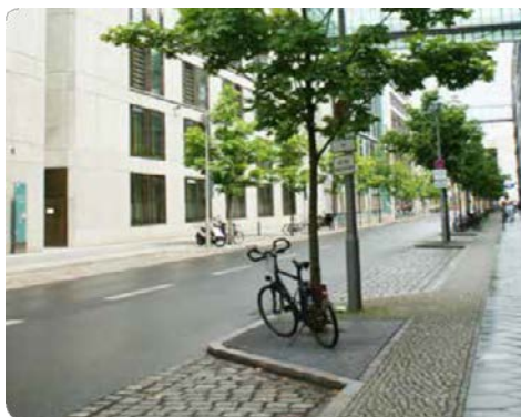
Exempel på vattengenomsläpplig beläggning och skelettjordsplanterade träd i Uppsala kommun.
