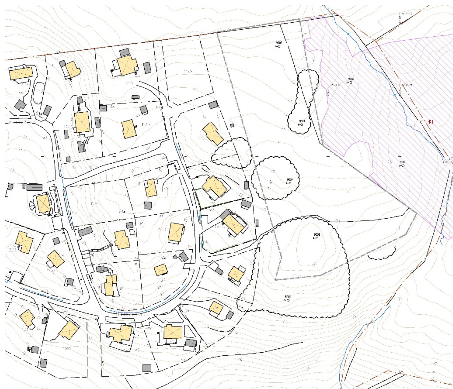
Karta från geoteknisk utredning (Bohusgeo, 2023.01.31). Svarta linjer markerar områden med ytnära eller synligt berg.
