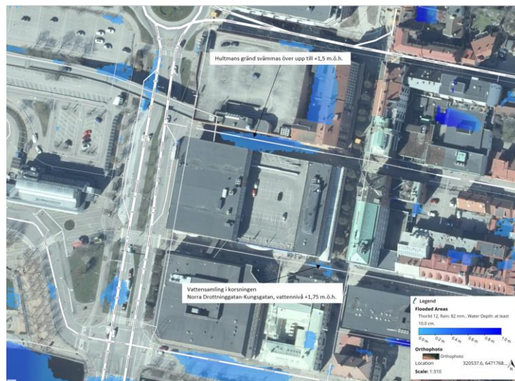
Figur 14. Ytor med vattensamling mer än 10 cm vid ett klimatanpassad 100-årsregn motsvarande 82 mm, är markerade med blåa fläckar. Nästan hela Hultmans Gränd, norr om planytan, kommer att översvämmas. Vatten samlas även vid korsningen Kungsgatan-Norra Drottninggatan. Källa: SCALGO Live.
