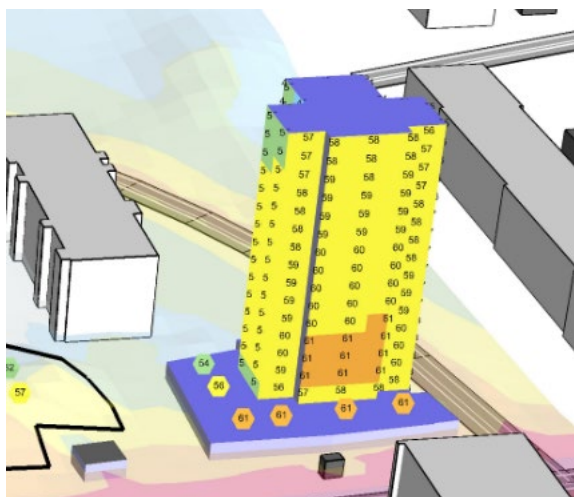
Figur 43. Ekvivalent bullernivå vid fasad för punkthus utan bullerreducerande åtgärder för gårdsterrass ovanpå sockelplanet Källa: Sweco
