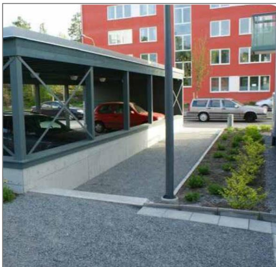
Figur 5-3. Exempel på genomsläpplig beläggning i form av grus (Uppsala Vatten, 2014).
