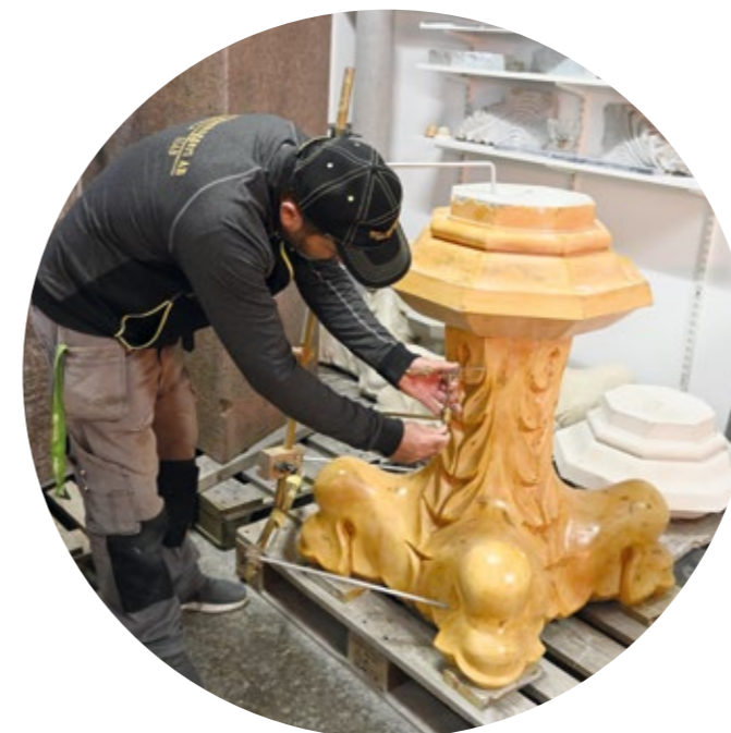
Paulos arbetar ofta med klassiska metoder och verktyg. Här visar han hur han använder ett verktyg som kallas "Pointing machine" som används i ungefär 2500 år.
