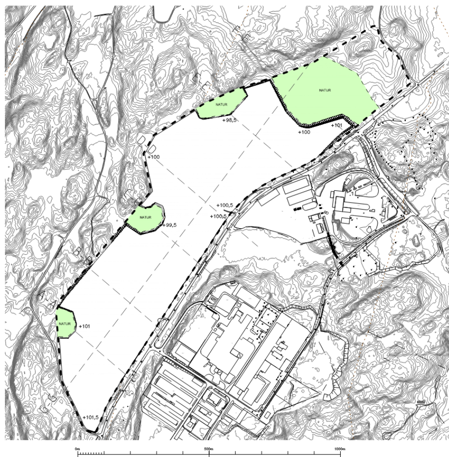
Figur 7: Planerad nivå på markytan efter exploatering av planområdet till industrimark.
