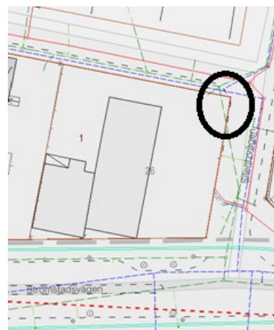
Figur 2. Befintlig dagvattenledning är inringad.
