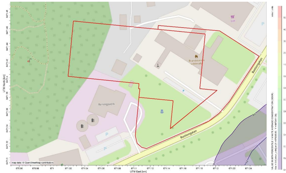
Figur 4. Lukt-koncentration runt Skansverket som 99-percentil minutmedelvärde för Scenario 2. Det planerade medborgarhuset är markerat med röd ram.
