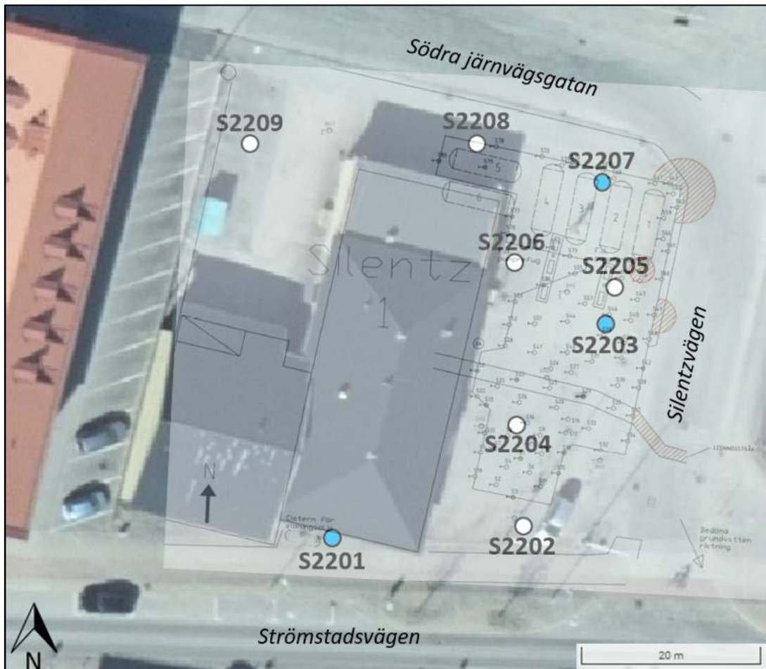
Figur 6. Lokalisering av skruvpunkter. Vid blå cirklar sattes grundvattenrör. I bilden har tidigare cisterner, pumpar och restförorening (röd skraffering) efter sanering lagts in.
