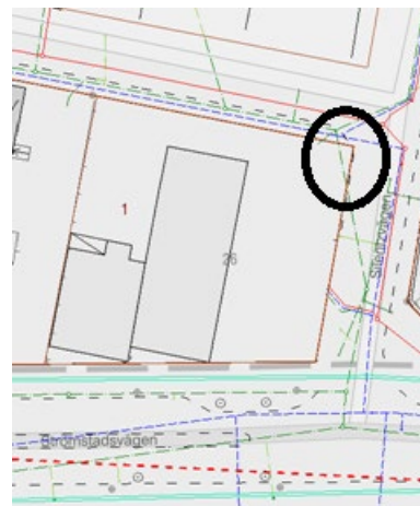
Figur 7. Befintlig dagvattenledning är inringad.
